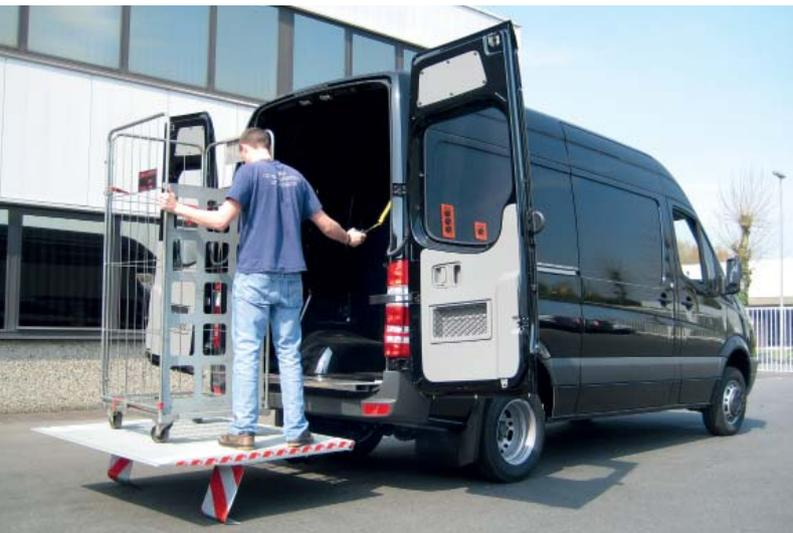
Le modèle DH-LSP était le premier modèle de hayon rabattable conçu sur mesure pour une installation dans les fourgons tôlés d'origine, et DHOLLANDIA est toujours à la tête des innovations dans ce domaine aujourd'hui. Grâce à la **forme unique des bras de levage**, aucune découpe ne doit être réalisée, ni dans le châssis du véhicule ni dans sa carrosserie, et la **garde-au-sol** sous le hayon est maximale.
